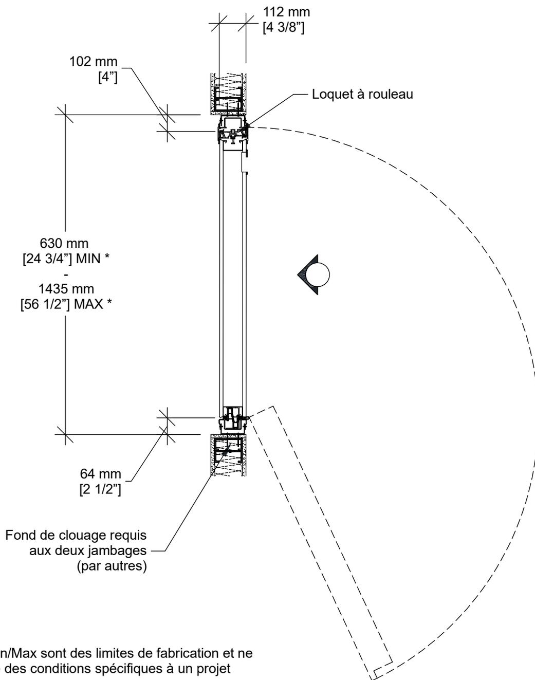
\* Les dimensions Min/Max sont des limites de fabrication et ne tiennent pas compte des conditions spécifiques à un projet donné.
