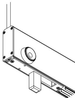
Serrure de plancher à pêne dormant et barillet à clé.
