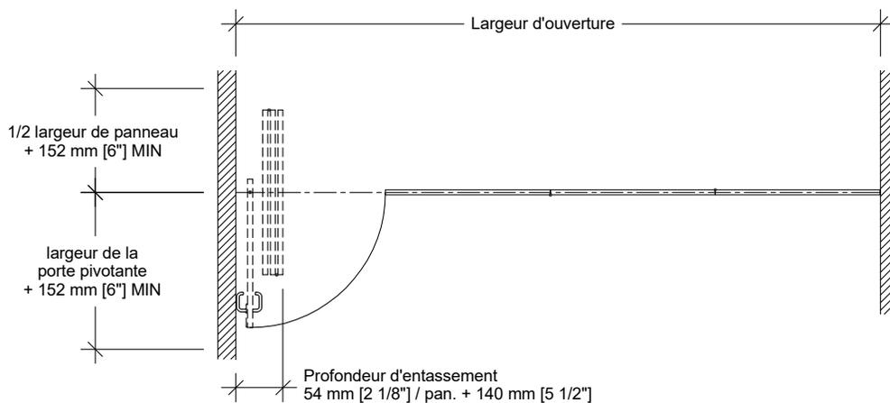
**Mur à mur – Fermeture par porte pivotante**
